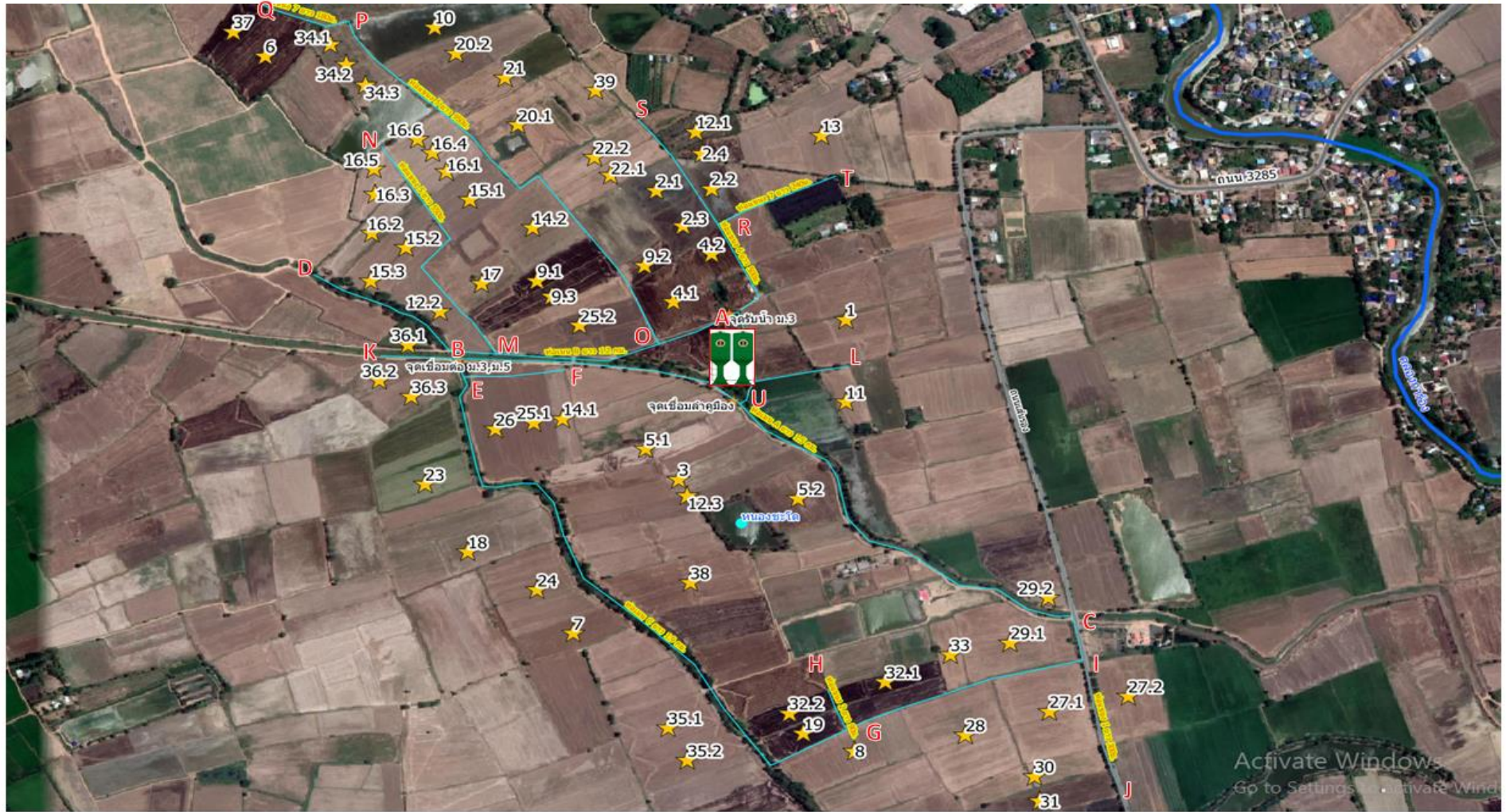
(ร่าง) แผนผังรายละเอียดระบบท่อกระจายน้ำบาดาลเพื่อการเกษตรแปลงใหญ่ กลุ่มเกษตรกรห้วยชัน ม.3 ต.ห้วยชัน อ.อินทร์บุรี จ.สิงห์บุรี (เกษตรกร 39 ราย พื้นที่รวม 620ไร่ 2 งาน)
